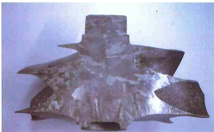
Figura 2 - Turbina onde a área de maior módulo apresenta estrutura de grãos espessos e colunares
